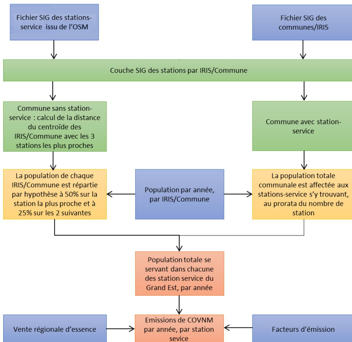
Figure 7 : Méthodologie globale de calcul des émissions liées aux stations-service
